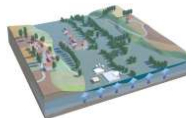
inondation de nappe
